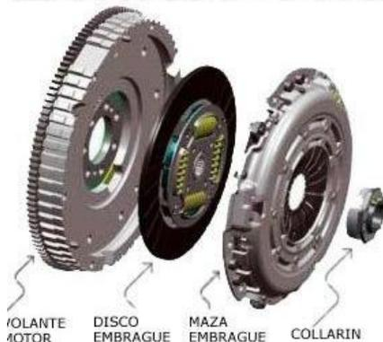
VOLANTE MOTOR DISCO EMBRAGUE MAZA EMBRAGUE COLLARIN
